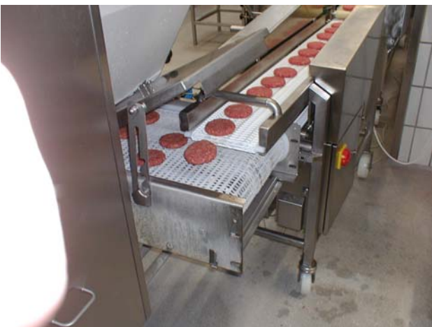
Shuttle conveyor til automatisk udlægning af burgere på indfrysningbånd.
