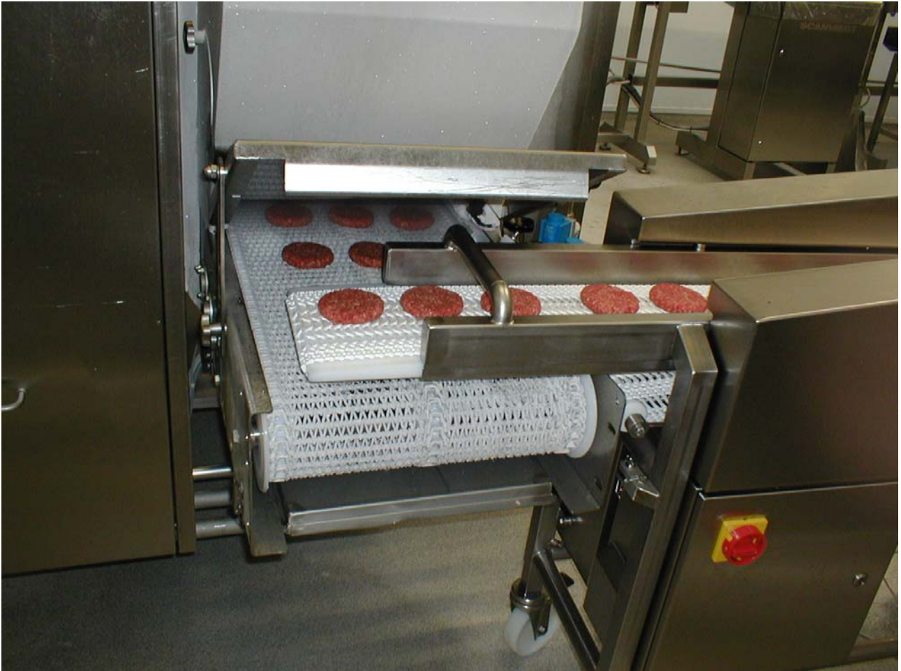
Shuttle conveyor til automatisk udlægning af burgere på indfrysningbånd.
