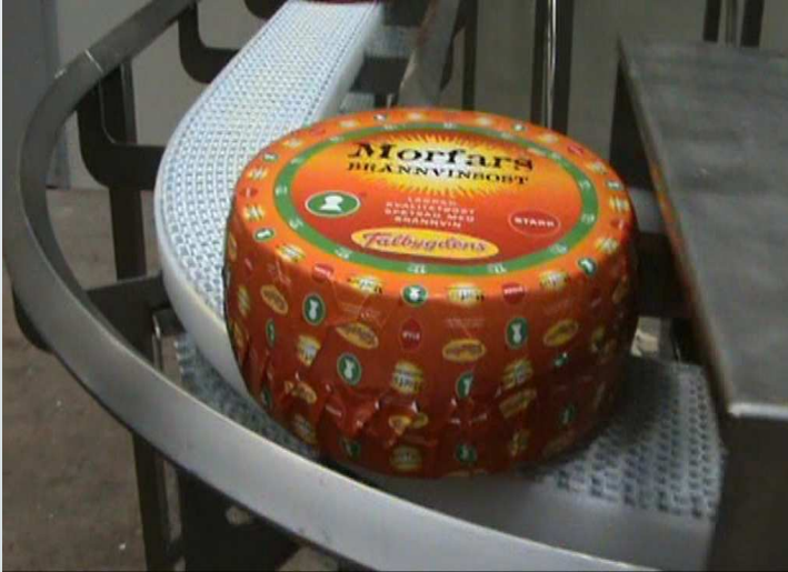
Udpakning, tørring, spritinjeksering, voksning, profilering af 9 ost/min
